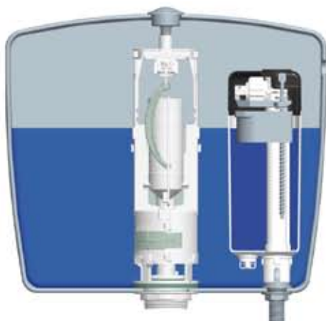
ROBINET FLOTTEUR EN POSITION FERMÉE
