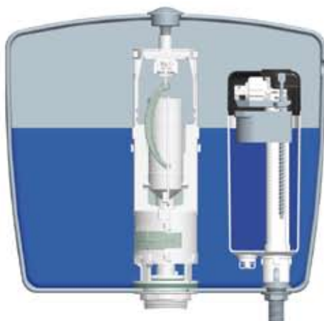
ROBINET FLOTTEUR EN POSITION FERMÉE
