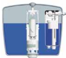
ROBINET FLOTTEUR EN POSITION FERMÉE
